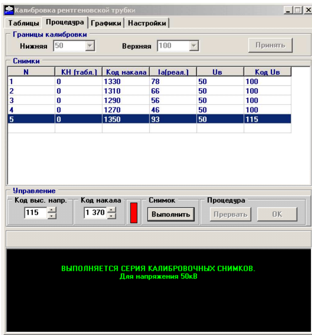
Рис. 5.7 Внешний вид окна «Калибровка рентгеновской трубки» на закладке «Процедура»
