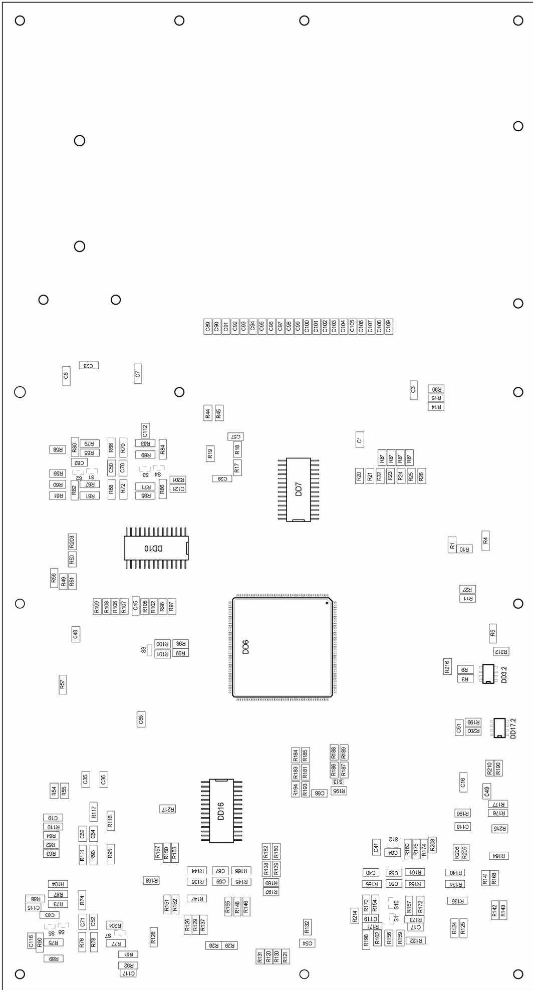
Рис. 2.11.7. Модуль CR-07. Схема расположения планарных элементов. Вид Сверху
