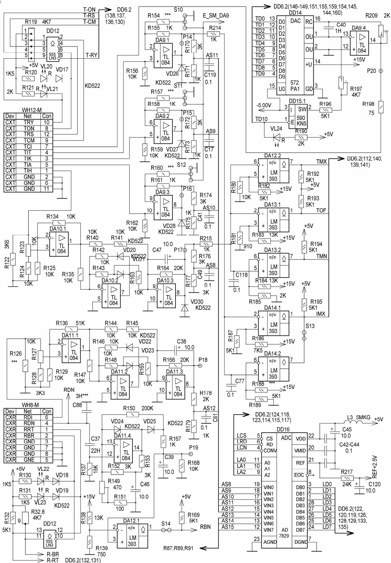
Рис. 2.11.5. Модуль CR07. Схема электрическая принципиальная. Лист 3.
