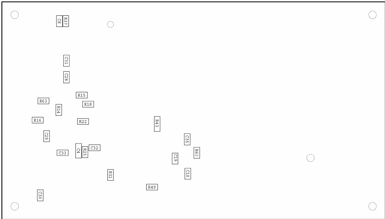
Рис. 2.7.3 Блок питания накала ТВ45. Схема расположения элементов. Вид снизу
